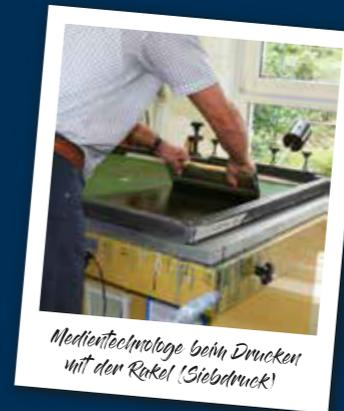
*Medientechnologe beim Drucken mit der Rakel (Siebdruck)*
