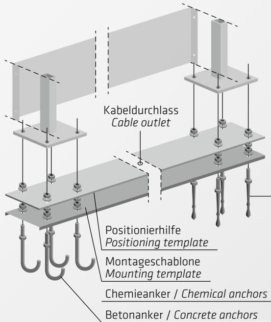
Fundament mit positioniertem Ankerkorb
