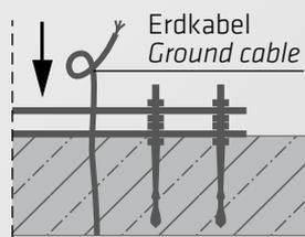
Fundament mit montiertem Ankerkorb
