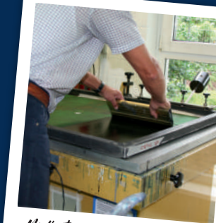
Medientechnologe beim Drucken mit der Rakel (Siebdruck)
