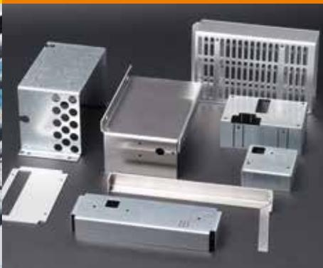
Einzelteile aus Blech oder Alu-Profil. Vervollständigt mit Zubehörelementen. Dieses können Verbindungselemente aller Art sein, sowie bedruckte Frontfolien, rückseitig aufgebrachte Klebefolien, genormte oder ungenormte Zubehörteile.
